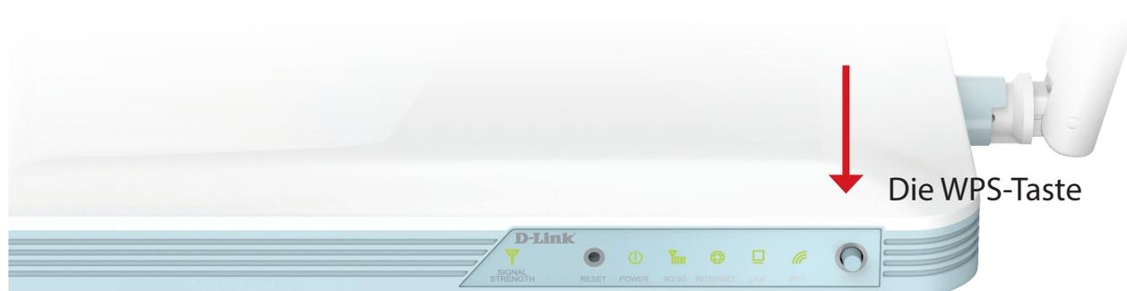
**Schritt 2** - Drücken Sie innerhalb von 2 Minuten auf die WPS-Taste auf Ihrem Wireless-Gerät (oder starten Sie das Softwareprogramm und den WPS-Prozess).
