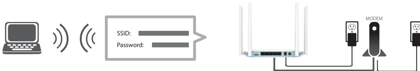
Wenn Sie den Router von einem PC mit einem Ethernet-Kabelanschluss konfigurieren, stecken Sie das eine Ende eines Ethernet-Kabels in den mit 1 gekennzeichneten Port auf der Rückseite des Routers und das andere Ende in den Ethernet-Port Ihres Computers.
