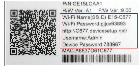
Si vous vous connectez au prolongateur pour la première fois et qu'aucune connexion n'a été établie, l'assistant de configuration apparaît automatiquement. Si le processus de configuration n'a pas été effectué auparavant, entrez le mot de passe par défaut du périphérique imprimé sur l'étiquette du périphérique à l'arrière du E15.
