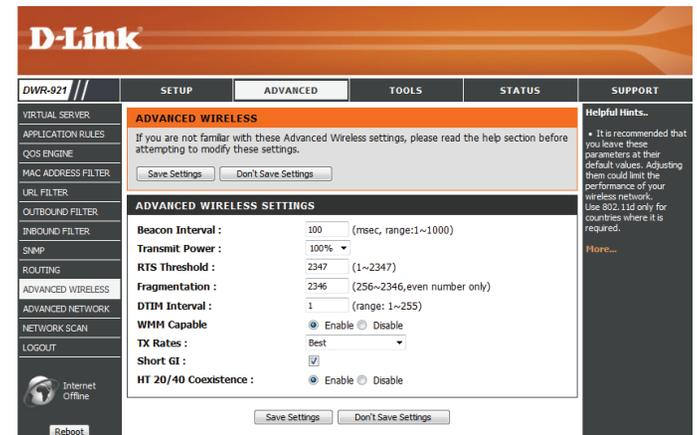
**Short GI (IG court) :** Cochez cette case pour réduire la durée de l'intervalle de garde à 400 ns. Cela peut augmenter le débit de transmission à condition que le délai de propagation de la connexion soit également faible. Cependant, il peut aussi augmenter le nombre d'erreurs sur certaines installations en raison de la sensibilité accrue aux réflexions de radiofréquence. Sélectionnez l'option la plus adaptée à votre installation.
