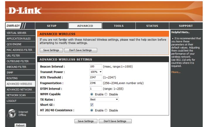
**IG court :** Cochez cette case pour réduire l'intervalle de garde à 400 ns. Cela peut augmenter le débit dans la mesure où la répartition du délai de la connexion est également faible. Cependant, il peut aussi augmenter le nombre d'erreurs sur certaines installations en raison de la sensibilité accrue aux réflexions de radiofréquence. Sélectionnez l'option la plus adaptée à votre installation.
