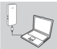
1. Zapněte DWR-720 a připojte jej ke svému PC pomocí dodaného kabelu mikroUSB.
