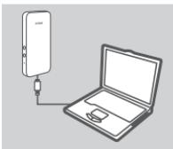
1. Vklopite DWR-720 in ga priključita na računalnik s pomočjo priloženega kabla Micro USB.
