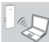
1. Vklopite DWR-720 in ga povežite z brezžičnim omrežjem dlink\_DWR-720\_xxxx, kjer so xxxx zadnje štiri številke naslova MAC usmerjevalnika DWR-720. Ime brezžičnega omrežja in geslo sta odtisnjena na nalepki pod baterijo.
