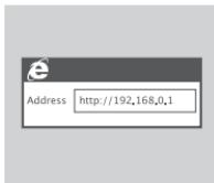
2. Anvend en web-browser til at gå til <http://192.168.0.1> for at logge på routerens konfigurationsinterface. Standard-brugernavnet er **admin**, og kodeordet efterlades tomt.
