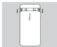
1. Retire a tampa da bateria na parte traseira do dispositivo deslizando-a para baixo. Depois, retire a bateria.
