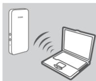
1. Encienda el DWR-720 y conecte el dispositivo a la red inalámbrica dlink\_DWR-720\_xxxx, donde xxxx representa los últimos cuatro dígitos de la dirección MAC del DWR-720. El nombre y la contraseña de esta red inalámbrica están impresos en la etiqueta ubicada debajo de la batería.
