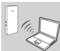
1. Zapněte DWR-720 a připojte zařízení k bezdrátové síti dlink\_DWR-720\_xxxx, kde xxxx jsou poslední čtyři číslice adresy MAC DWR-720. Název této bezdrátové sítě a heslo je vytisknuto na štítku pod baterií.
