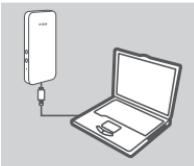
1. Tænd DWR-720, og tilslut den til din PC ved hjælp af det medsendte mikro-USB-kabel.
