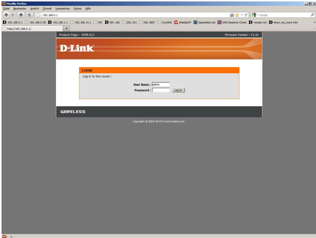
Sie können den DWR-512 so einstellen, dass er eine 3G-Internetverbindung als Backup nutzt, also im Falle eines Ausfalls der PPPoE-Internetverbindung, dann auf die 3G-Internetverbindung umschaltet. Sobald die PPPoE-Internetverbindung wieder verfügbar ist, schaltet er von der 3G wieder auf die PPPoE-Internetverbindung.
