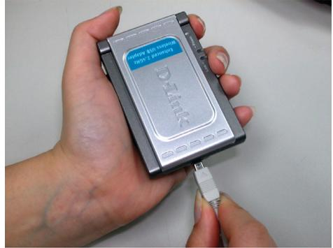
C. Verbinden Sie dann das andere Kabelende (das Ende mit dem kleineren Steckverbinder) mit dem DWL-120+ Adapter.
