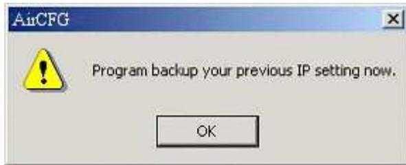
Wenn Sie unter **Profile IP Settings** das Kontrollkästchen **Disable** angeklickt haben, zeigt das Air Management-Hilfsprogramm folgendes Dialogfenster an, um zu bestätigen, dass die IP-Einstellungen von Windows verwendet werden. Ihre **profile** IP-Einstellungen werden vom System gespeichert.
