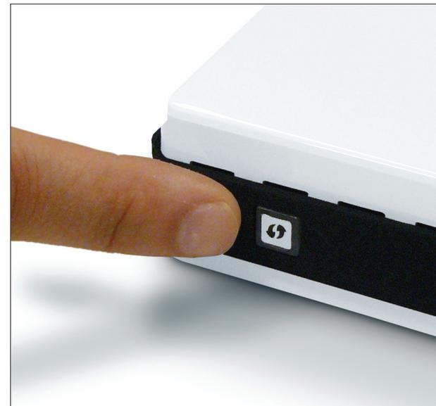
Appuyez sur le bouton WPS situé sur l'adaptateur pendant deux secondes, jusqu'à ce que l'écran de l'utilitaire apparaisse. Appuyez ensuite sur le bouton WPS du point d'accès ou du routeur pour continuer.
