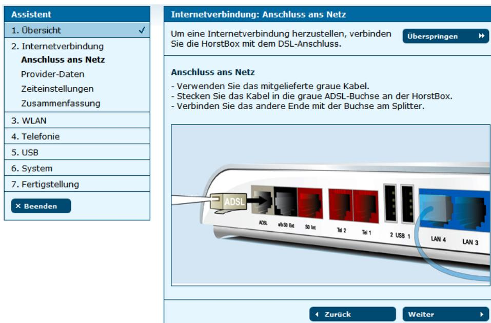
Abbildung 3.3: Internetanschluss: Anschluss ans Netz
