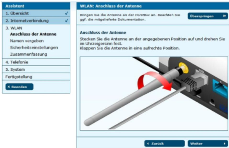
Abbildung 3.8: WLAN: Anschluss der Antenne
