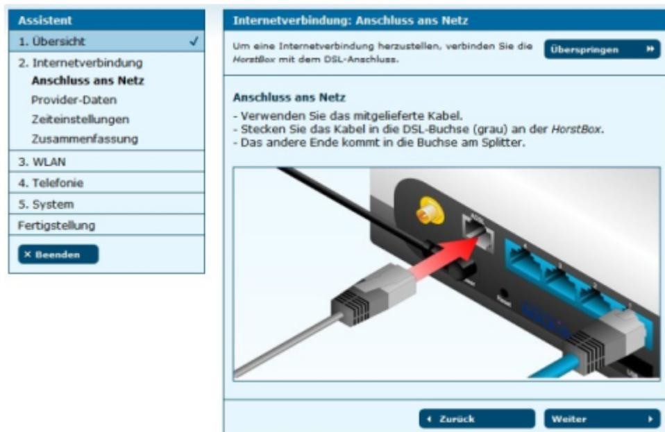
Abbildung 3.3: Internetanschluss: Anschluss ans Netz
