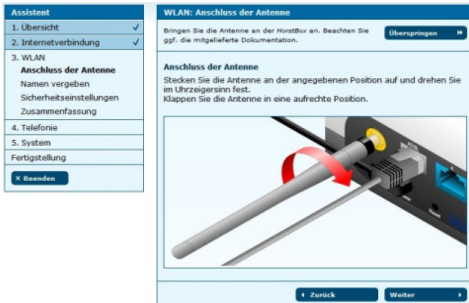
Abbildung 3.8: WLAN: Anschluss der Antenne
