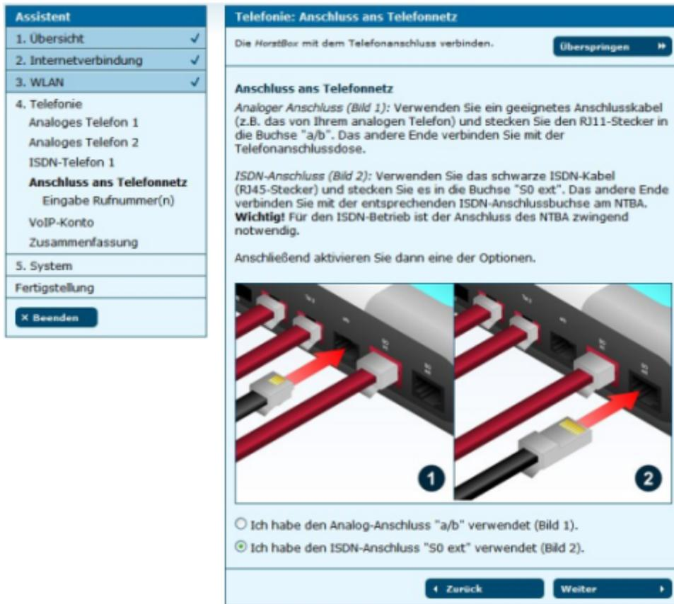
Abbildung 3.20: Telefonie: Anschluss an das Telefonnetz
