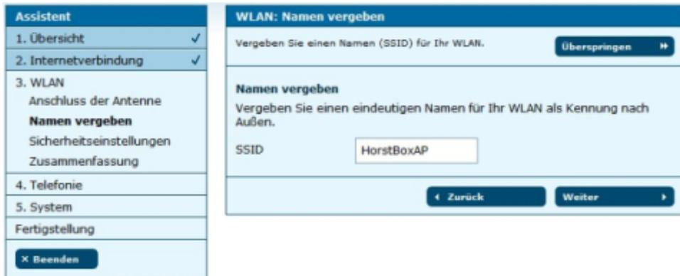
Abbildung 3.9: WLAN: Name (SSID) vergeben
