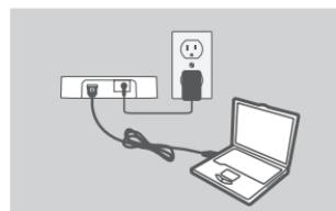
3. Sett den rektangulære enden av den medfølgende USB-kabelen i en ledig USB-port på datamaskinen.
