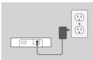
1. Stecken Sie den kleinen Stecker am Kabel des Steckernetzteiles in die Buchse auf der Rückseite des DUB-H4. Stecken Sie das Steckernetzteil in eine Wandsteckdose. Die LED auf dem DUB-H4 leuchtet grün, um anzudeuten, dass der Hub Strom empfängt.
