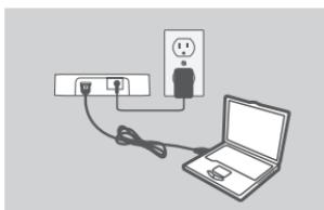
3. Stecken Sie den USB-Stecker Typ A (flach) des mitgelieferten USB-Kabels in einen verfügbaren USB-Port Ihres Computers.
