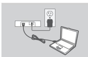
3. Podłącz prostokątną końcówkę dołączonego do urządzenia kabla USB do wolnego portu USB w komputerze.
