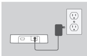
1. Branchez l'adaptateur secteur dans le connecteur situé à l'arrière du DUB-H4. Connectez l'autre extrémité dans une prise murale. Le voyant sur le DUB-H4 s'allume en vert pour indiquer que le concentrateur est sous tension.
