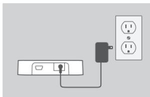
1. Collegare l'alimentatore al connettore situato nel retro del dispositivo DUB-H4. Collegare l'altra estremità a una presa a muro. Il LED sul dispositivo DUB-H4 diventerà verde per indicare che l'hub è alimentato.
