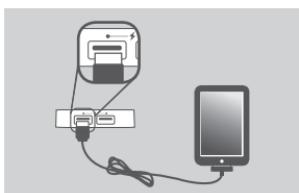
4. Ihr Computer erkennt automatisch die Treiber für den DUB-H4 und installiert sie. Sie können nun USB 2.0 oder USB 1.1 Geräte an die USB-Ports auf der Vorderseite des DUB-H4 anschließen.
