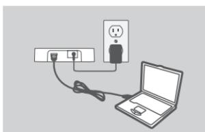
3. Csatlakoztassa a csatolt USB kábel négyzet alakú végét egy szabad USB portba a számítógépen.
