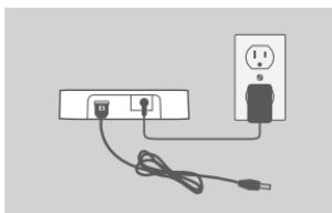
2. Steek het kleinere uiteinde (Mini-B USB) van de meegeleverde USB-kabel in het achterpaneel van de DUB-H4.
