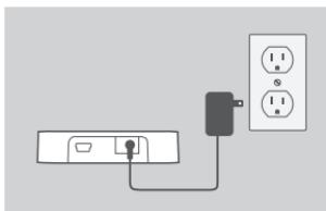
1. Csatlakoztassa a tápadaptert a DUB-H4 hátulján található csatlakozóba. A másik végét dugja a fali aljzatba. A DUB-H4 jelzőfénye zöldre vált, jelezve, hogy a hub tápellátáshoz jut.
