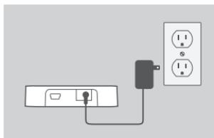
1. Anslut nätagtappern till kontakten på baksidan av DUB-H4-enheten. Anslut den andra änden till ett vägguttag. Lysdioden på DUB-H4-enheten tänds och lyser grönt vilket indikerar att hubben är strömförsljrd.
