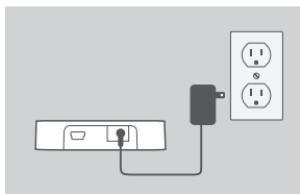
1. Priklučite strujni adapter na priključnicu na poleđini uređaja DUB-H4. Drugi kraj priključite na zidnu utičnicu. Zasvijetlit će kontrolna lampica uređaja DUB-H4 označavajući da je uključeno napajanje čvorišta.
