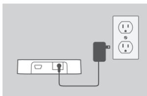
1. Enchufe el adaptador de alimentación en el conector situado en la parte posterior del DUB-H4. Enchufe el otro extremo a una toma de pared. El LED del DUB-H4 cambiará a verde para indicar que el concentrador está recibiendo alimentación.
