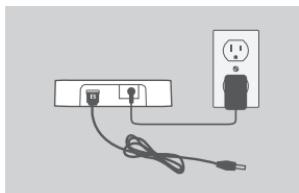
2. Collegare l'estremità più piccola (USB mini-B) del cavo USB in dotazione nel retro del dispositivo DUB-H4.
