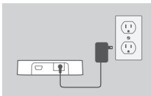
1. Steek de stroomadapter in de connector op het achterpaneel van de DUB-H4. Steek het andere uiteinde in een wandstopcontact. De LED op de DUB-H4 wordt groen om aan te geven dat de hub stroom krijgt.
