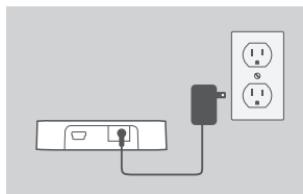
1. Ligue o adaptador de corrente ao conector na parte traseira do DUB-H4. Ligue a outra extremidade a uma tomada eléctrica. O LED no DUB-H4 ficará verde para indicar que o hub está a receber energia.
