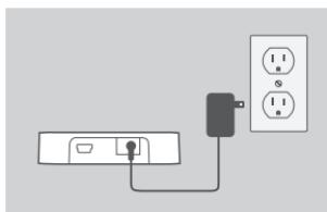
1. Vključite napajalni adapter v priključek na zadnji strani DUB-H4. Drugi konec kabla vključite v električno vtičnico. Lučka LED na DUB-H4 zasveti zeleno in označi, da se razdelilnik napaja.
