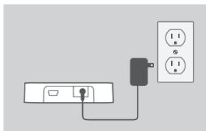
1. Podłącz zasilacz do łącznika znajdującego się z tyłu DUB-H4. Podłącz drugi koniec do gniazda na ścianie. Dioda LED na DUB-H4 zaświeci się na zielono, co oznacza, że hub jest zasilany.
