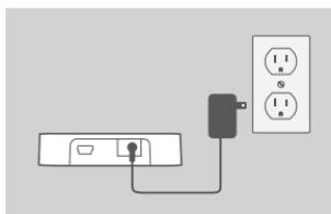
1. Conectați adaptorul de alimentare la conectorul localizat pe partea din spate a hubului DUB-H4. Conectați celălalt capăt la o priză de perete. LED-ul de pe hubul DUB-H4 devine verde pentru a indica faptul că hubul este alimentat.
