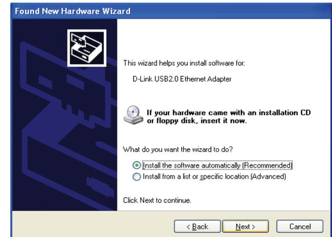
Une fois le pilote Windows XP installé, vous pouvez connecter le DUB-E100 à un port USB de votre ordinateur. Passez ensuite à la section **Connexion de l'adaptateur à un réseau** en page 14.
