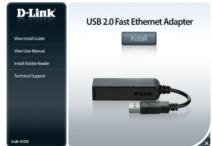
Wenn der InstallShield-Assistent die Installation abgeschlossen hat, schließen Sie den DUB-E100 an einem USB-Port Ihres PCs an. Die Installation der Treibersoftware wird dann automatisch abgeschlossen.
