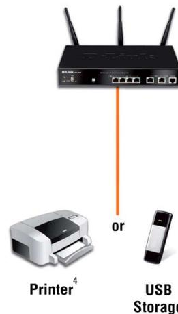
Verfügt über einen (DSR-250N/DSR-500N) bzw. zwei (DSR-1000N) USB 2.0 Ports, um externe Festplatten oder Drucker<sup>4</sup> am Router anzuschließen und gemeinsam im WLAN und LAN zu nutzen.
