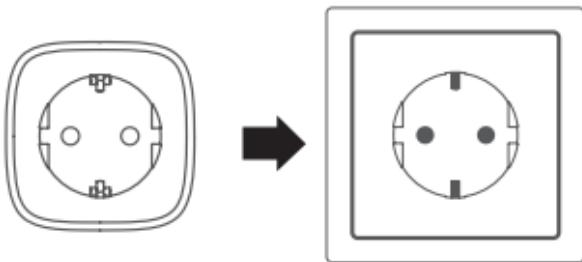
Enchufe el Mini Wi-Fi Smart Plug a una toma de alimentación. Espere a que el LED de la parte delantera cambie de rojo a naranja intermitente.
