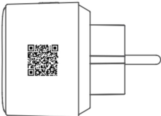
Când vi se cere să scanăți un Cod de configurare, acesta se va afla în partea dreaptă a Mini Wi-Fi Smart Plug.
