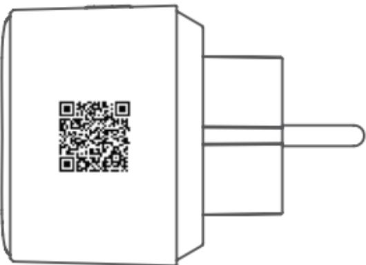
Meta tintalab tiskennja Kodiċi ta' Konfigurazzjoni, din tinstab fuq in-naħha tal-lemin ta' Mini Wi-Fi Smart Plug tiegħek.
