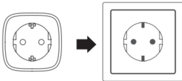
Collegare Mini Wi-Fi Smart Plug a una presa elettrica.
