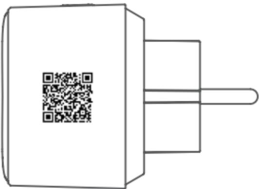
Kod instalacji, który należy zeskanować, znajduje się z prawej strony sterownika Mini Wi-Fi Smart Plug.
