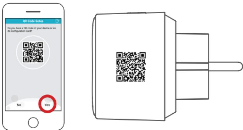
Quando viene chiesto di scansionare un Codice di configurazione, questo verrà collocato sul lato destro del Mini Wi-Fi Smart Plug.
