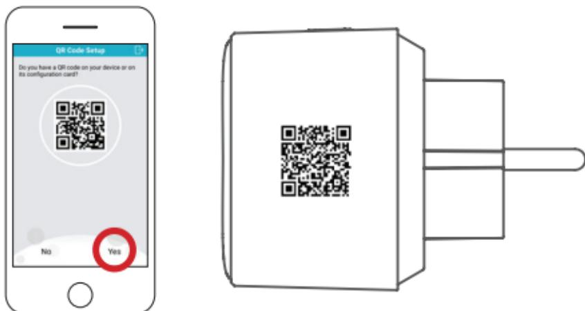
Når du blir bedt om å skanne en konfigurasjonskode, finner du den på høyre side av Mini Wi-Fi Smart Plug.
