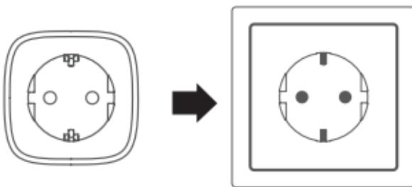
Podłącz sterownik Mini Wi-Fi Smart Plug do gniazda elektrycznego. Poczekaj aż dioda LED z przodu zmieni światło z czerwonego na migające pomarańczowe.
