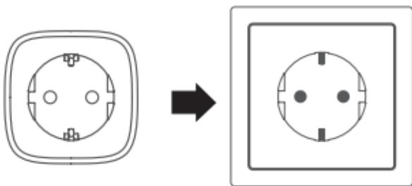
Zapojte Mini Wi-Fi Smart Plug do elektrickej zásuvky.
