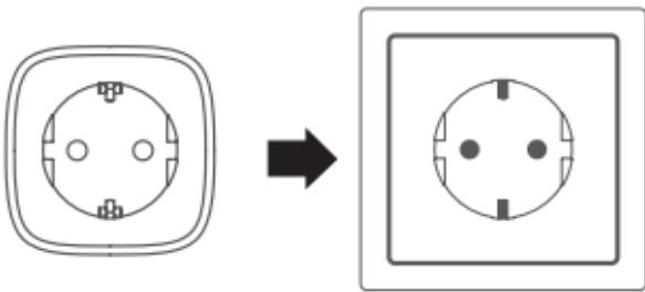
Schließen Sie den Mini Wi-Fi Smart Plug an eine Steckdose an. Warten Sie, bis die LED auf der Vorderseite von rot zu gelb blinkend wechselt.
