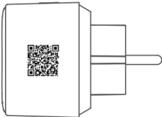
Cuando se le pida que escanee un código de configuración, se encontrará en el lado derecho de su Mini Wi-Fi Smart Plug.
