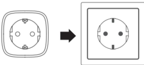
Introduceți Mini Wi-Fi Smart Plug într-o priză. Așteptați până când LED-ul din față își schimbă culoarea din roșu în portocaliu pulsatoriu.
