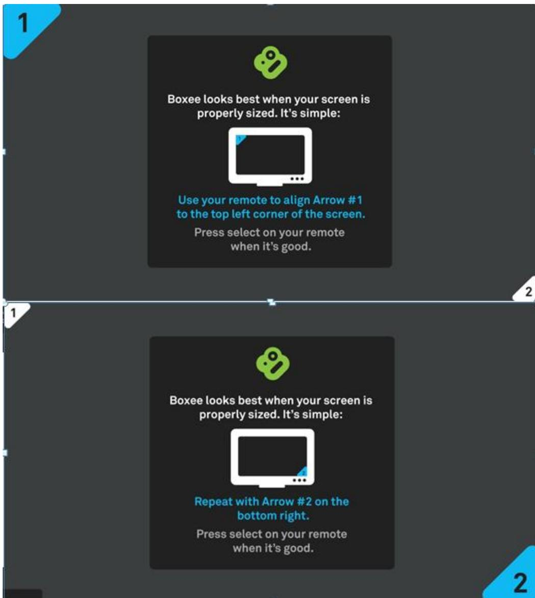
Nachdem die Kalibrierung erfolgt ist, kann die Einstellung mit der Fernbedienung bestätigt werden, oder erneut durchgeführt werden.
