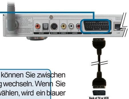
Mit der Taste **VIDEO OUT** auf der Fernbedienung können Sie zwischen Composite/S-Video-Ausgang und SCART-ausgang wechseln. Wenn Sie den SCART-Anschluss verwenden, aber nicht auswählen, wird ein blauer Bildschirm angezeigt.
