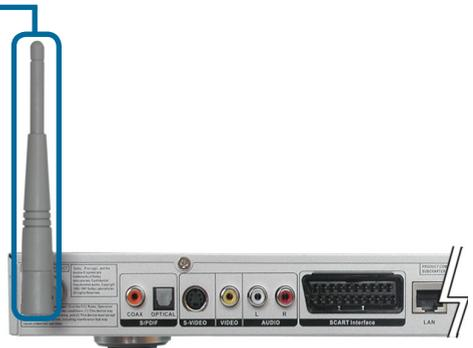
Hinweis: Sie können ein Networkkabel und eine Antenne für eine drahtlose Netzwerkverbindung an das Gerät anschließen. Die beiden Netzwerkverbindungen (verdrahtet und drahtlos) beeinträchtigen einander nicht, können jedoch nicht gleichzeitig genutzt werden. Die Art der Netzwerkverbindung wird im Installationsassistenten gewählt und kann über das Setup-Menü geändert werden. Mit der Taste SETUP auf der Fernbedienung gelangen Sie in das Setup-Menü.
