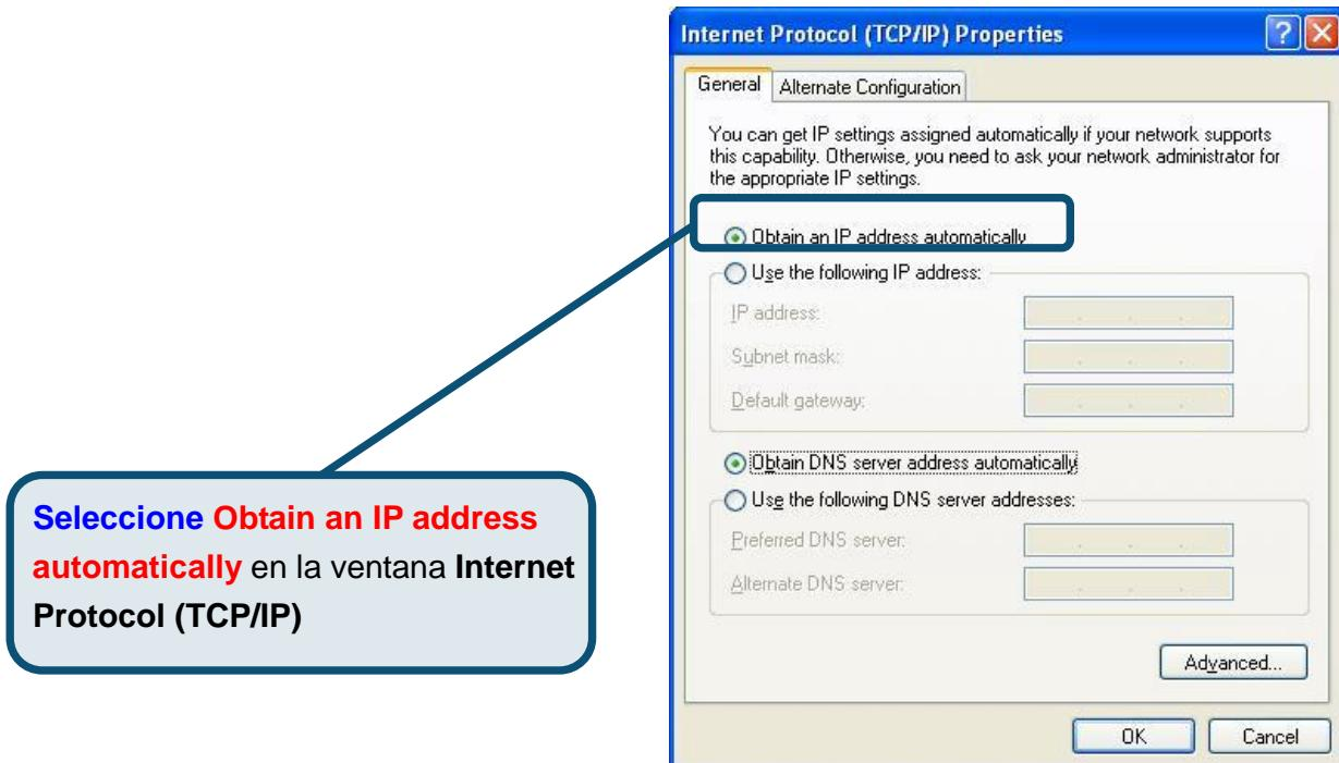
El ordenador está listo para utilizar el servidor DHCP del router.
