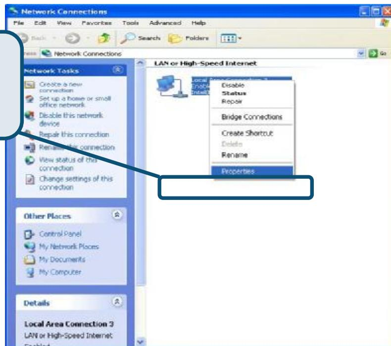
3. Dans l'onglet **Général** du menu **Propriétés de la connexion locale**, sélectionnez **Protocole Internet (TCP/IP)** sous « Cette connexion utilise les éléments suivants », en cliquant dessus une fois. Cliquez sur le bouton **Propriétés**.
