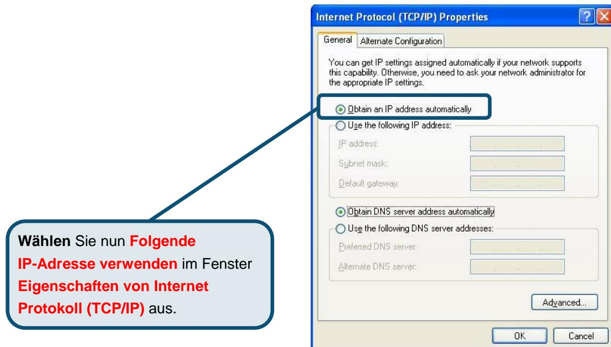
Der Computer ist nun so konfiguriert, dass der DHCP-Server des Routers verwendet wird.
