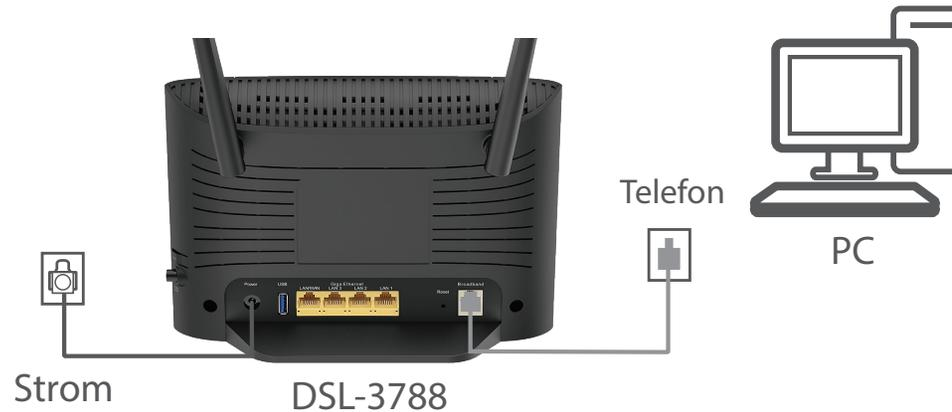
Stecken Sie das eine Ende des im Lieferumfang enthaltenen Ethernet-Kabels in den gelben Ethernet-Port auf der Rückseite des Modem-Routers und das andere Ende in den Ethernet-Port Ihres Computers.
