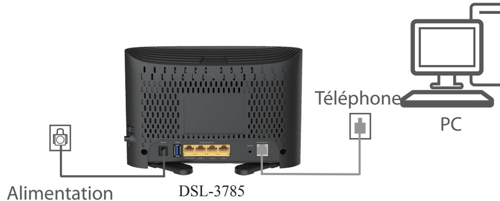
Branchez une extrémité du câble Ethernet fourni sur le port Ethernet jaune à l'arrière du routeur modem et l'autre extrémité, au port Ethernet de votre ordinateur.
