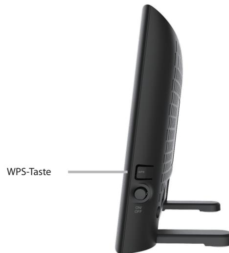
**Schritt 2** - Drücken Sie innerhalb von 2 Minuten auf die WPS-Taste auf Ihrem Wireless-Gerät (oder starten Sie das Softwareprogramm und den WPS-Prozess).
