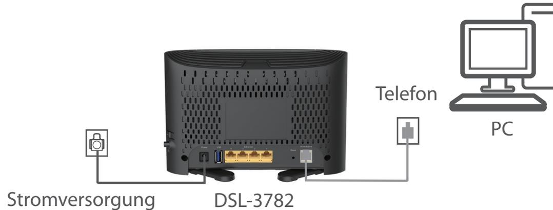
Stecken Sie das eine Ende des im Lieferumfang enthaltenen Ethernet-Kabels in den gelben Ethernet-Port auf der Rückseite des Modem-Routers und das andere Ende in den Ethernet-Port Ihres Computers.
