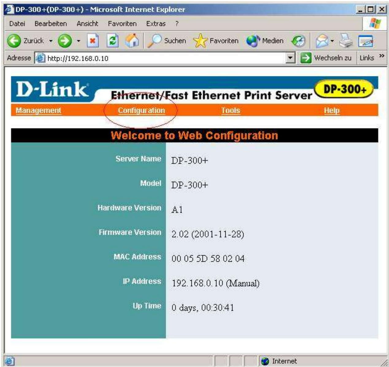
gehen Sie nun durch drücken auf den „**Configuration**“ Button in der Menüzeile in das Configuration Menü.
