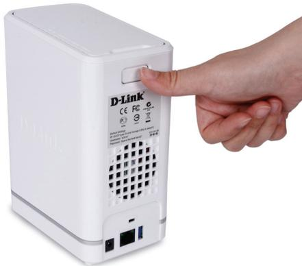
**Schritt 1** - Nehmen Sie die Deckenplatte ab, indem Sie auf der Rückseite des Geräts fest auf die Verriegelungsklinke drücken.
