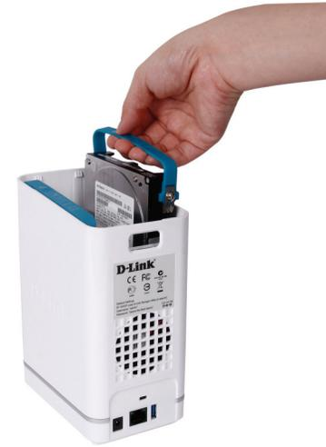
**Schritt 4** - Setzen Sie bis zu zwei 3,5" SATA-Festplattenlaufwerke in die Laufwerkschächte ein.
