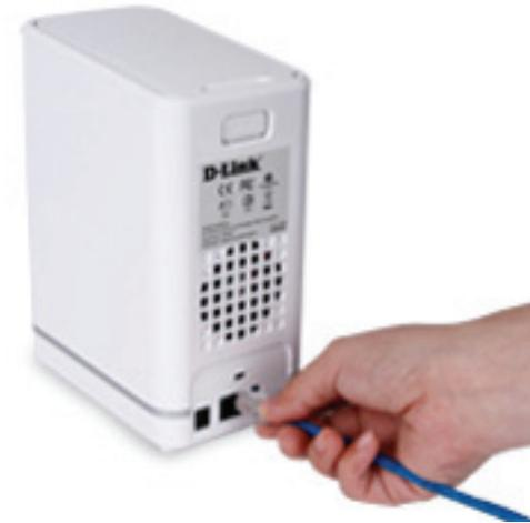
**Schritt 6** - Schließen Sie ein Ethernet-Kabel an den Ethernet-Port an. Mit diesem Kabel wird das ShareCenter™ über einen Router oder Switch mit Ihrem lokalen Netzwerk oder direkt mit einem Computer zwecks Konfiguration verbunden (dazu ist die Verwendung eines Cross-over-Kabels erforderlich).
