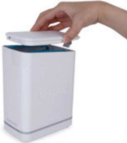
**Schritt 5** - Bringen Sie die Deckenplatte wieder an. Stellen Sie sicher, dass dabei die Verriegelungsklinke in die Platte eingesetzt wird.
