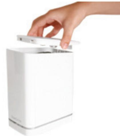
**Schritt 2** - Sobald die Abdeckung entriegelt ist, nehmen Sie sie von dem Gerät. Die Laufwerkschächte des Geräts werden sichtbar.
