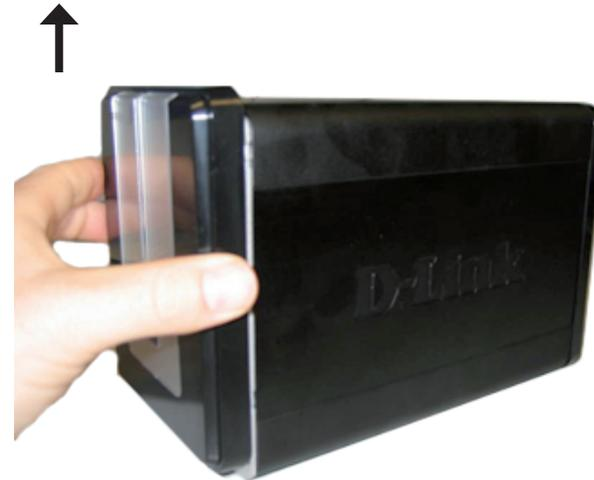
2. Wenn die Abdeckung ausgeklinkt ist, ziehen Sie sie aus dem Gerät. Die Laufwerkeinschübe sind nun sichtbar.
