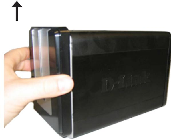
2. Sobald die Frontplatte entfernt ist, legen Sie diese beiseite, um die Laufwerksschächte freizugeben.
