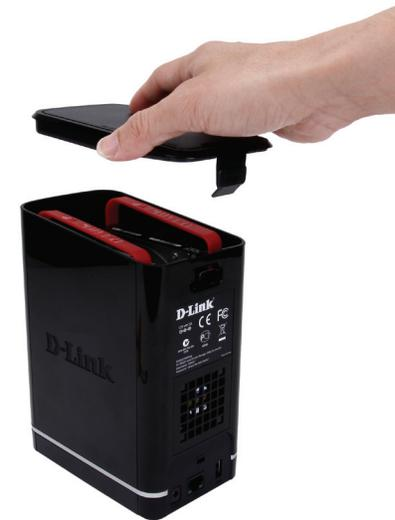
**Schritt 2** - Sobald die Abdeckung entriegelt ist, nehmen Sie sie von dem Gerät. Die Laufwerkschächte des Geräts werden sichtbar.
