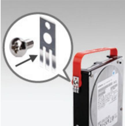
**Schritt 3** - Bringen Sie die Halterungen an den Seiten Ihrer Festplattenlaufwerke mithilfe der mitgelieferten Schrauben an. Stellen Sie sicher, dass die Halterungen so ausgerichtet sind, dass der Pfeil auf der Halterung beim Einsetzen der Festplatte zur Vorderseite des ShareCenter hin zeigt.
