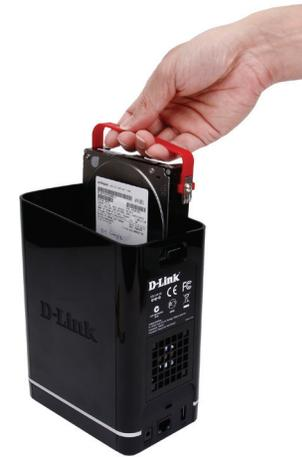
**Schritt 4** - Setzen Sie bis zu zwei 3,5" SATA-Festplattenlaufwerke in die Laufwerkschächte ein.
