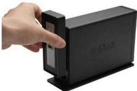
2. Wenn die Frontplatte gelöst ist, legen Sie diese beiseite. Nun haben Sie ungehinderten Zugriff auf den Laufwerksschacht.
