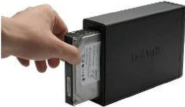
3. Setzen Sie eine **3,5" SATA**-Festplatte in den Laufwerksschacht ein. Richten Sie die Laufwerksanschlüsse auf die Endpunkte im DNS-313 aus, und schieben Sie das Laufwerk vorsichtig ein, bis es einrastet.
