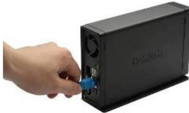
5. Verbinden Sie das Ethernetkabel mit dem freien Ethernetanschluss. Dieses Kabel dient dem Anschluss des DNS-313 zur Konfiguration an das lokale Netzwerk oder direkt an den Computer.
