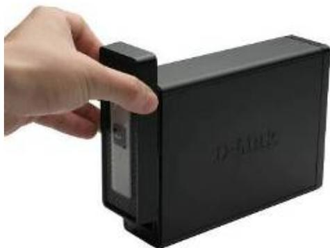
1. Öffnen Sie den Laufwerksschacht, indem Sie die Frontplatte nach oben schieben, bis diese sich abnehmen lässt.
