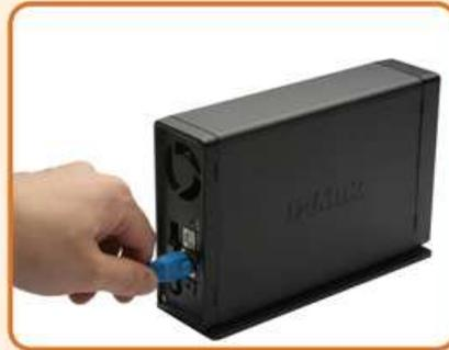
Verbinden Sie den Ethernet-Anschluss des Geräts über ein Ethernet-Kabel mit dem Router oder dem Ethernet-Anschluss an Ihrem Computer. Klicken Sie anschließend auf **WEITER**.
