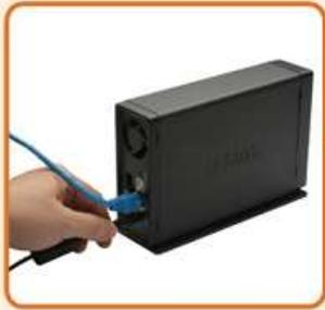
Verbinden Sie das Netzteil mit der Stromversorgungsbuchse des Geräts, und schließen Sie es dann an eine Steckdose an.
