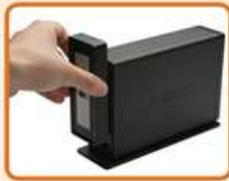
Für den Zugriff zum Laufwerksschacht entfernen Sie die Frontplatte, indem Sie diese nach oben und dann zu sich heran bewegen.
