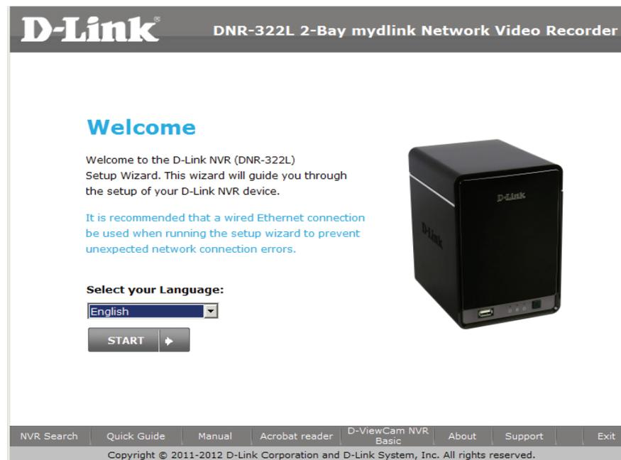
**Remarque :** L'ordinateur utilisé pour accéder au gestionnaire de configuration Web du NVR doit se trouver sur le même sous-réseau que le NVR. Si votre réseau utilise un serveur DHCP, le NVR se trouve automatiquement sur le même sous-réseau.
