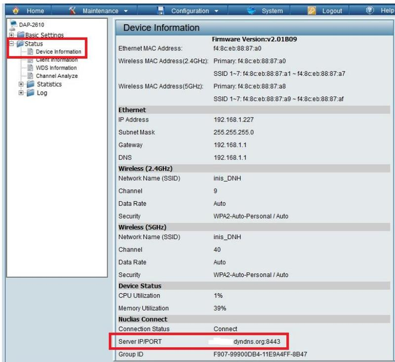
7. Trennen Sie den DAP nun aus dem Netzwerk und bringen ihn an den externen Ort. Starten Sie ihn dort und stellen sicher, dass an diesem externen Ort die Internetverbindung zur Verfügung steht.
