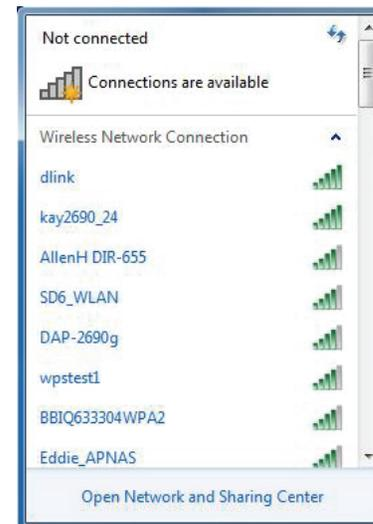
3. Markieren Sie die drahtlose Verbindung mit dem Wi-Fi-Namen (SSID), zu der Sie eine Verbindung herstellen möchten, und klicken Sie auf **Connect** (Verbinden).
