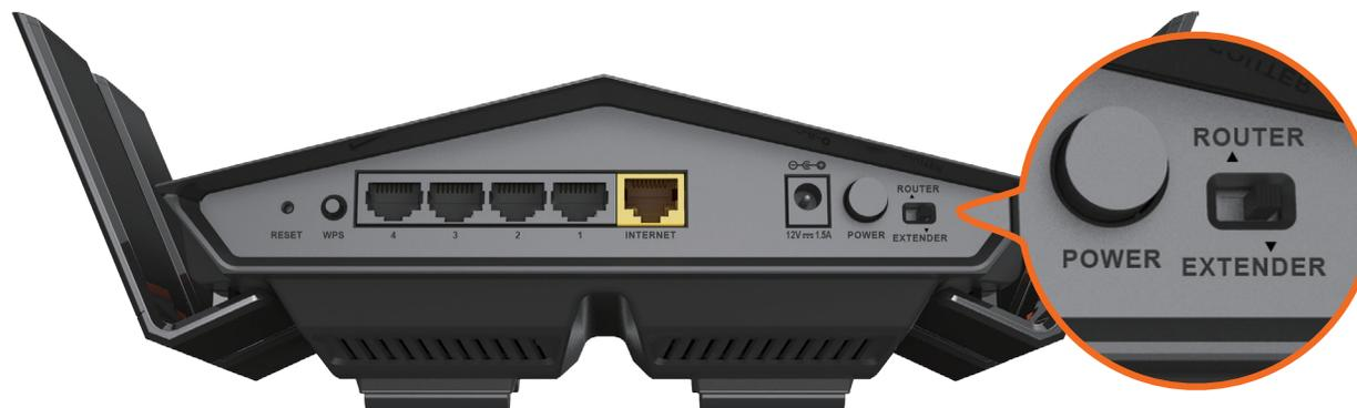
**Hinweis:** Bestimmen Sie Ihre gewünschte Betriebsart und stellen Sie den Schalter entsprechend ein, bevor Sie Ihre Installation beginnen. Wird der Modusschalter eingestellt, während das Gerät eingeschaltet ist, führt der DIR-869 nach fünf Sekunden in dem neuen Modus einen Neustart durch.
