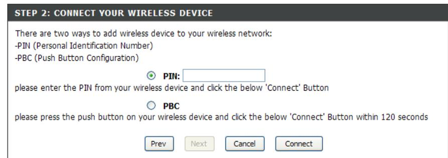
**PBC:** Wählen Sie diese Option, um einen drahtlosen Client mit Hilfe der PBC (Push Button Concept)-Methode hinzuzufügen. Klicken Sie auf **Connect** (Verbinden).
