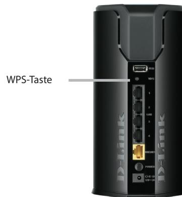
**Schritt 2** - Drücken Sie innerhalb von 2 Minuten auf die WPS-Taste auf Ihrem drahtlosen Client (oder starten Sie das Softwareprogramm und den WPS-Prozess).
