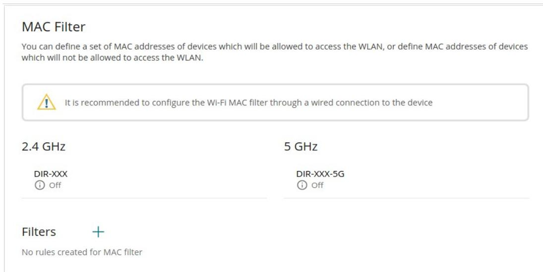
Abbildung 142. Die Seite zum Konfigurieren des MAC-Filters für das drahtlose Netzwerk.
