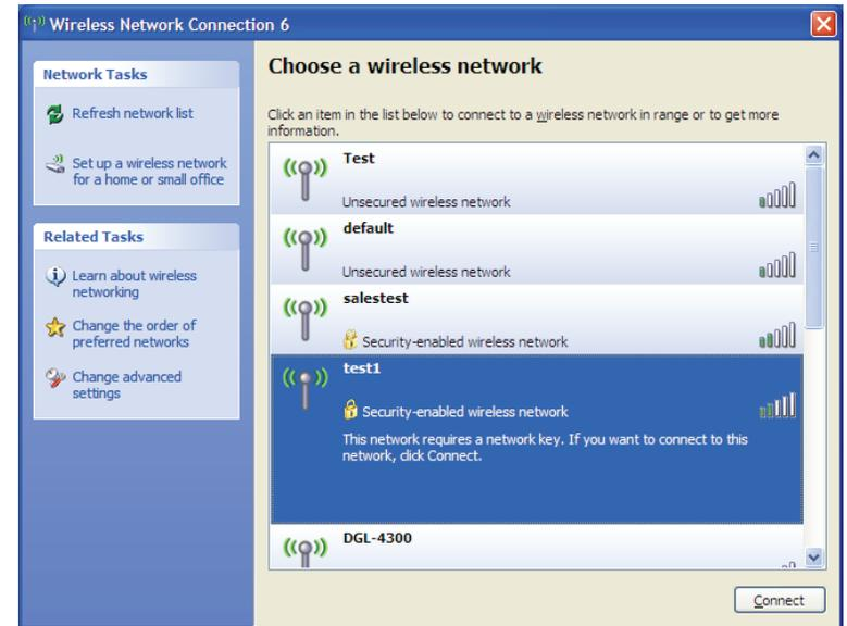
3. La boîte de dialogue **Wireless Network Connection** (Connexion réseau sans fil) apparaît. Saisissez le mot de passe Wi-Fi WPA-PSK, puis cliquez sur **Connect** (Connexion).
