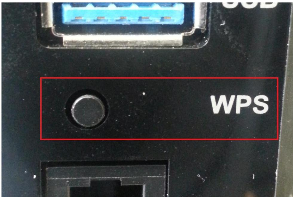
7. Der Verbindungsversuch mittels WPS dauert maximal zwei Minuten.
