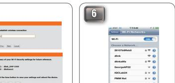
Wählen Sie die Konfigurationsmethode und klicken Sie auf **Next** (Weiter). Um die Konfiguration manuell durchzuführen, wählen Sie das Wi-Fi-Netz, zu dem der DIR-505 drahtlos eine Verbindung herstellen soll.
