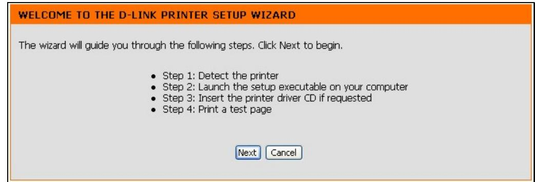
Der Drucker wird in der Regel sofort gefunden. Es wird dann der Modellname angezeigt. Sollte kein Drucker erkannt worden sein, erscheint die Meldung, dass die Druckerinstallation nicht durchgeführt werden kann. Prüfen Sie die Kabelverbindungen und stellen Sie sicher, dass der Drucker eingeschaltet ist. Klicken Sie auf „**Next**“ (**Weiter**), wenn ein Drucker erkannt wurde.
