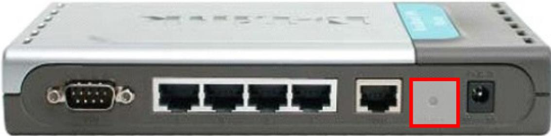
Der D-Link DI-804HV kann auf die Fabrikeinstellungen zurückgesetzt werden, wenn Sie den Rücksetzschalter für einige Sekunden (nicht mehr als 5!) drücken, während das Gerät eingeschaltet ist. Verwenden Sie einen Stift oder eine Büroklammer, um den Schalter vorsichtig zu drücken. Die Standard-IP-Adresse des Routers ist 192.168.0.1, die Subnetzmaske 255.255.255.0, der Standardbenutzer heißt *admin*. Es wurde kein Standardpasswort vergeben.
