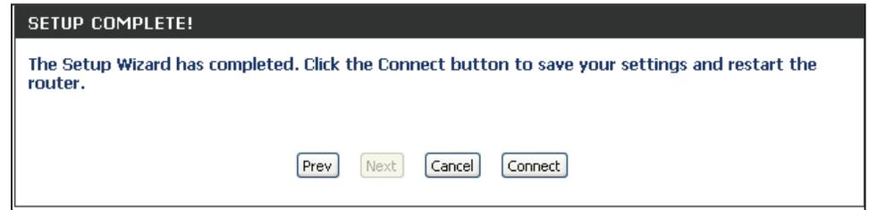
La fenêtre suivante s'ouvre pour indiquer que les paramètres sont en cours d'enregistrement. Lorsque le routeur a enregistré toutes les modifications, la fenêtre **Setup > Internet** (Configuration > Internet) s'ouvre.
