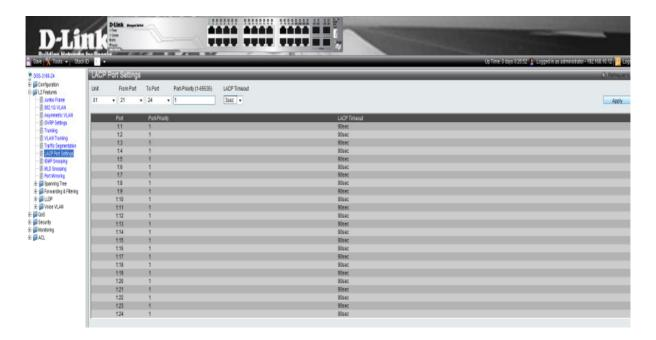
Nach dem Anlegen des LACP Trunks bitte bei Bedarf den LACP Timeout und die Portprioritäten anpassen. 90 Sekunden (Standard, long) oder 3 Sekunden (short). Der LACP Timeout ist der Wert, nachdem das LACP Protokoll bei einer Fehlererkennung automatisch anfängt einzelne Ports des LAG zu entfernen oder hinzuzufügen. Mit "Apply" übernehmen Sie Ihre Einstellungen.
