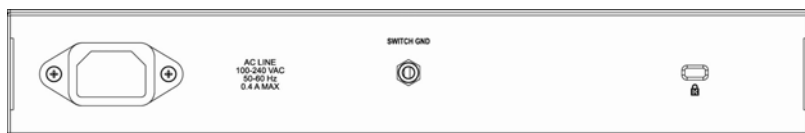
Vue de la façade arrière du commutateur
