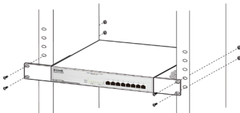
Figure 3 - Montage du commutateur dans le bâti
