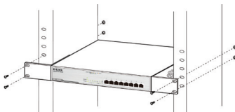
Figura 3: installazione dello switch nel rack
