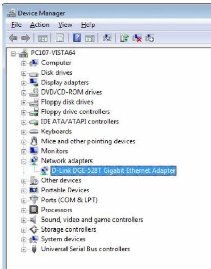
Для проверки успешности инсталляции **DGE-528T** проверните вниз меню и щелкните по “**Network adapters**”.
