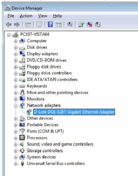
Para verificar se a instalação do **DGE-528T** foi bem sucedida, faça scroll down e clique em “**Network Adapters**.”
