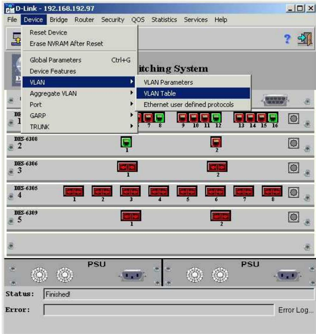
nun gehen Sie über den Button Insert in das Vlan einfügen Menü
