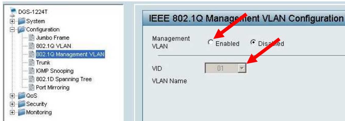
So kann verhindert werden das von einem der PCs aus den Unternehmen auf das Konfigurationsmenü des Switches zugegriffen werden kann.
